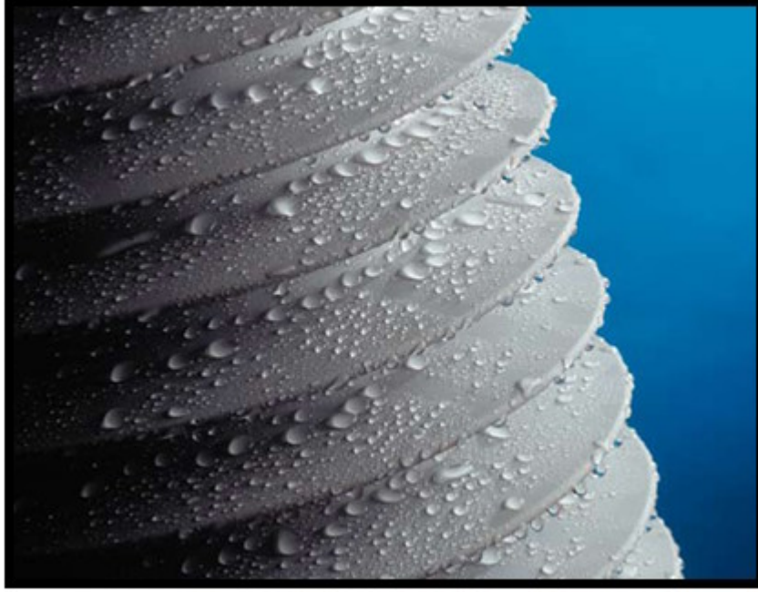
الشكل (2 - 1) يبين خاصية رفض الماء على العوازل السيليكونية
