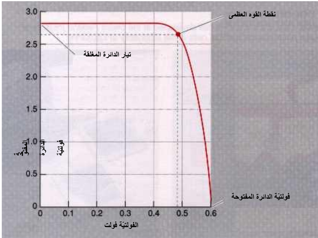
شكل (3-5): منحنى خصائص الفولتية والتيار لخلية سلكونية تحت الظروف الاعتيادية
