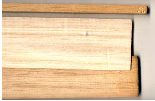
شكل رقم (١٧) أشكال وسماكات خشب البلس
