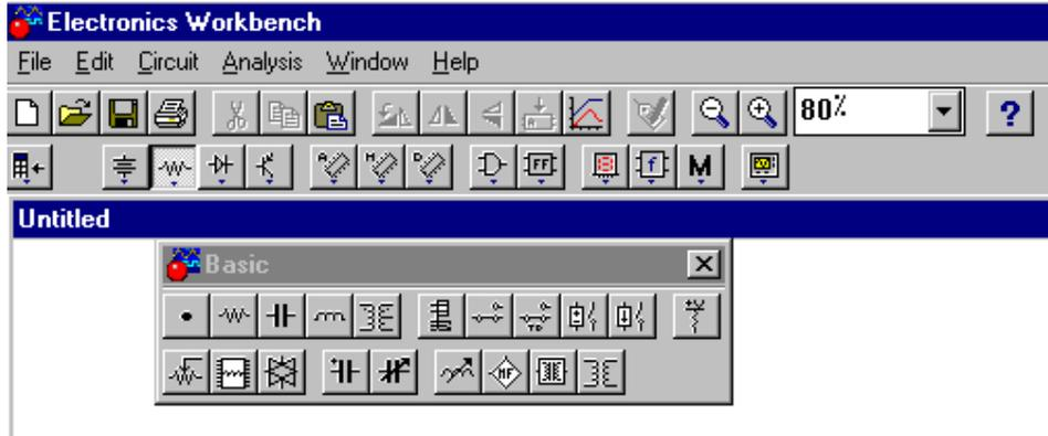
٣- شريط الثنائي (Diodes): عن طريق هذا الشريط يتم اختيار وتحديد مواصفات الثنائي (Diode) ويمكن اختيار الثنائي المثالي (ideal diode) أو اختياره بالرقم واسم الشركة كما في الأشكال التالية.
