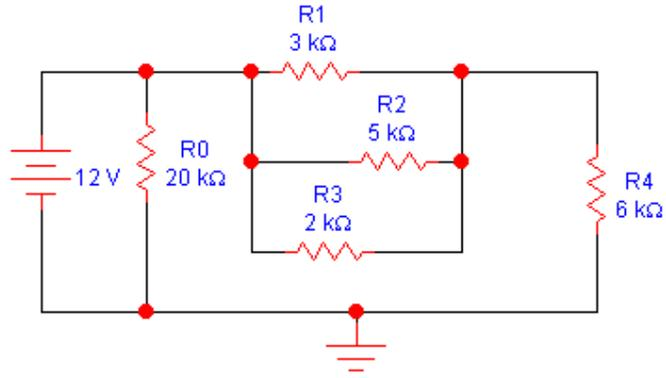
قم بقياس التيار المار في كل مقاومة.
