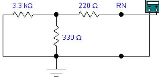
ما هو اسم الجهاز المستخدم لقياس المقاومة؟ احسب قيمة المقاومة نظرياً وقارنها بالقيمة المقاسة بالجهاز.
