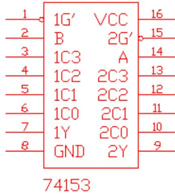
هذه الدائرة تحتوي على دائرتين للاختيار من الحجم 4x1، تشتركان في مداخل الاختيار (A , B)، وتختلفان في مداخل البيانات (C0,C1,C2,C3). ومن التدريب السابق اتضح لنا الحاجة لعدد 4 Multiplexers من الحجم 4x1 وتشترك جميعها في مداخل الاختيار، كل منها مسئول عن تحديد إحدى الخانات. لذا فالدائرة الجزئية النهائية للـ Multiplexers هي كالتالي:
