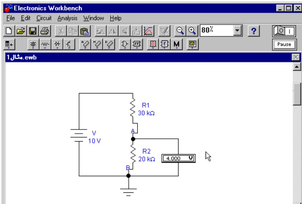
لاحظ أن مفتاح الطاقة في وضع التشغيل و يظهر بداخل جهاز قياس الجهد القيمة  $4.000\text{ V}$  والمطابقة للقيمة المحسوبة سابقاً.
