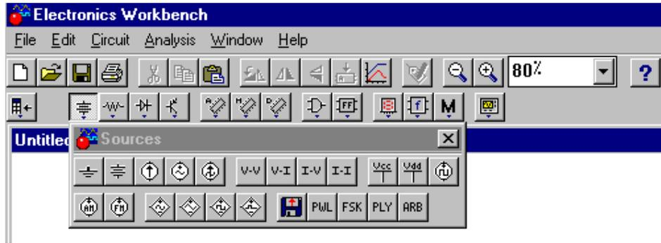
٢- شريط القطع الأساس (Basics): يشتمل هذا الشريط على القطع الأساسية المكونة لمعظم الدوائر مثل المقاومات، المكثفات؛ المفاتيح وغيرها من القطع كما هو موضح بالشكل التالي
