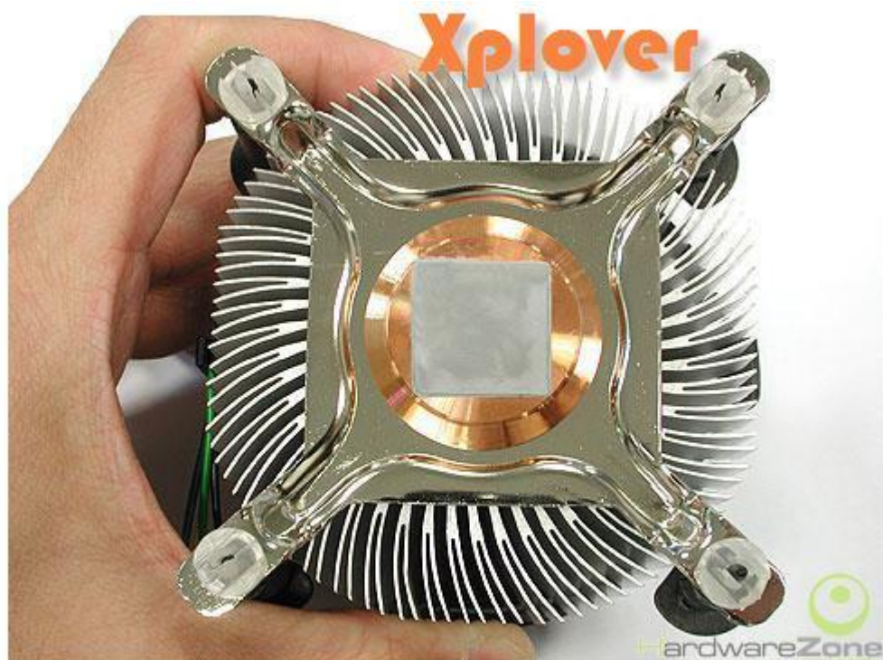
المجمع الحراري قبل تطبيقه تأكد انك ازلت الغطاء الحراري على المجمع قبل التركيب.
