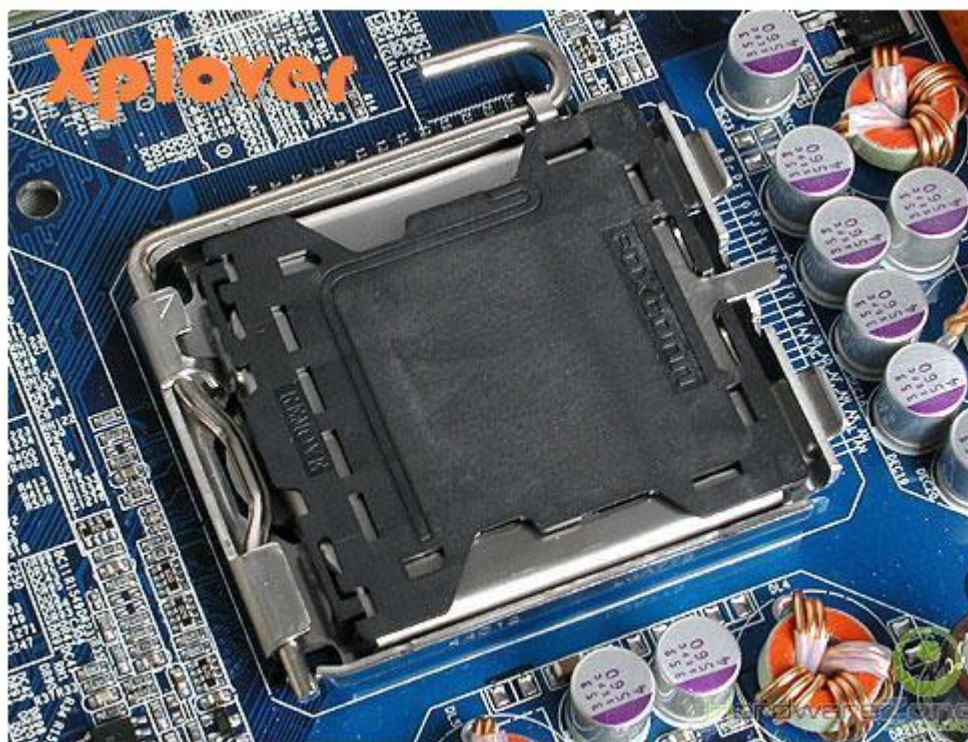
سوكيت LGA775 على لوحة الام البيات على السوكيت محمية ب غطاء بلاستيك اثناء نقلها
