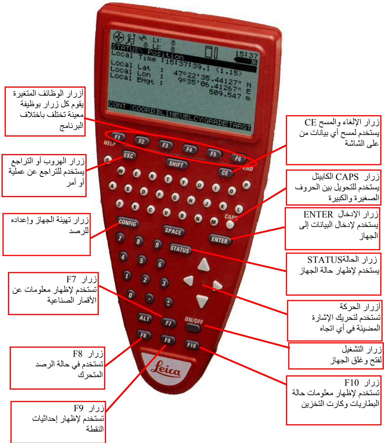
شكل رقم (5 - 27) : يوضح وظيفة كل زرار في لوحة المفاتيح
