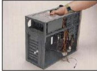
٤- قم بوضع وحدة الإمداد بالطاقة في مكانها الصحيح ثم قم بتثبيتها بواسطة البراغي الخاصة بها .
