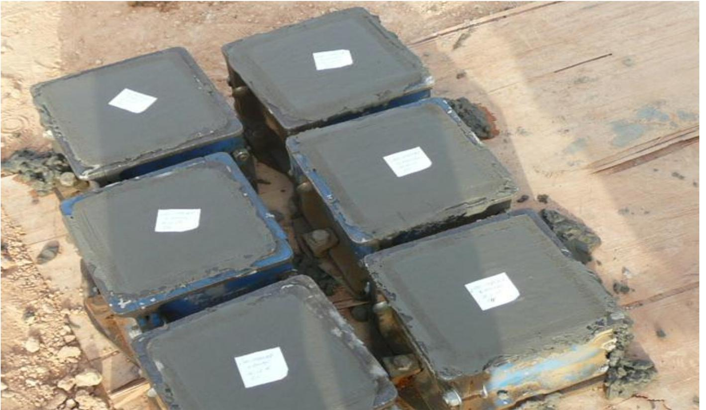
وبعد ذلك يتم معالجة الخرسانة بالمياه لمدة ٧ ايام واستعمال الخيش المبلل لتخفيف درجة حرارة الخرسانة ويفضل الرش بالمياه ليلا
