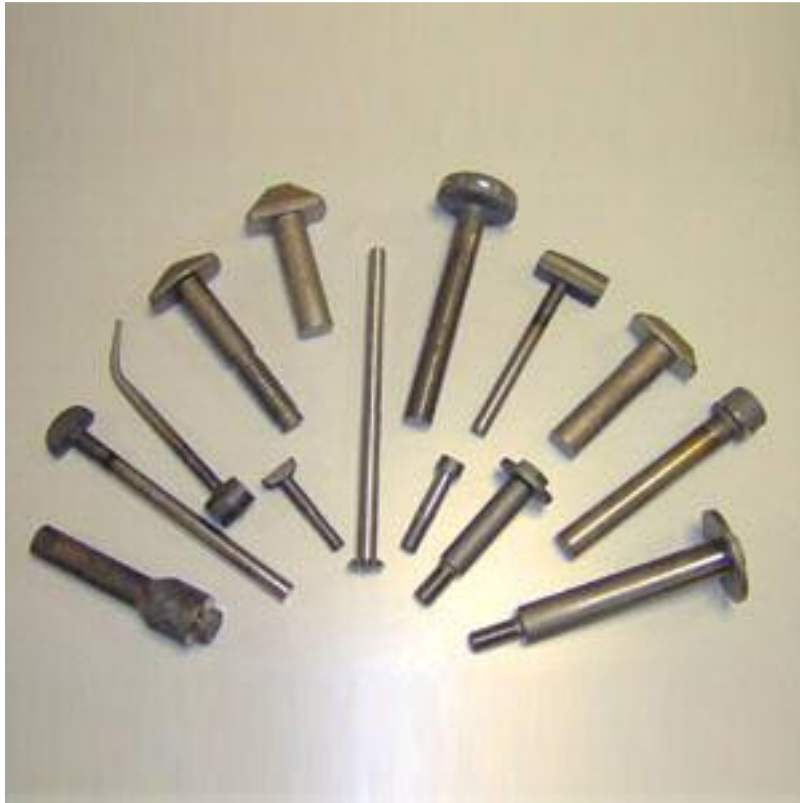
شكل (٤-١٥) أجزاء مصنعة بطريقة صنع الرأس
