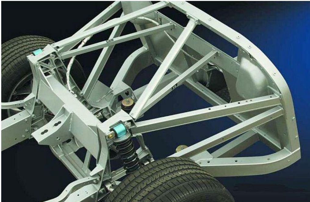
شكل (٤-٥) سيارات حديثة مصنوعة من لحام مقاطع مبنوقة
