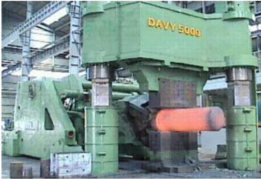
شكل (٤-٥) صورة لعملية طرق بقالب مفتوح
