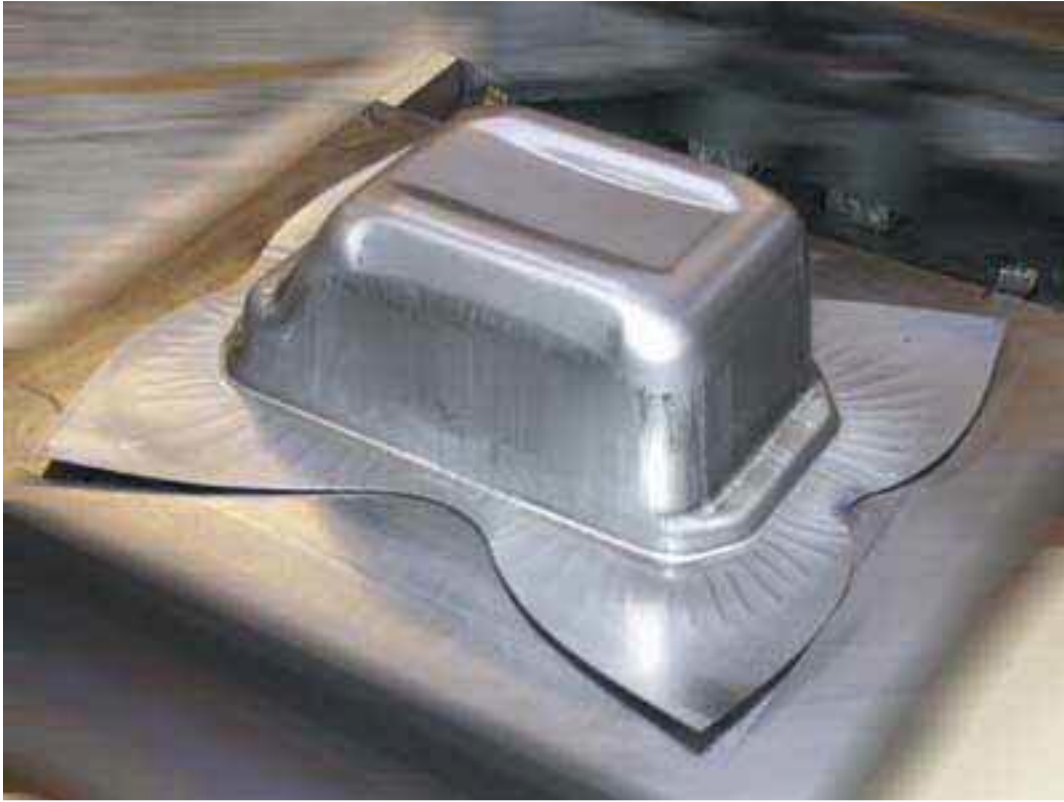
شكل (٧-١٥) منتج مصنوع بطريقة السحب قبل عملية التحديد
