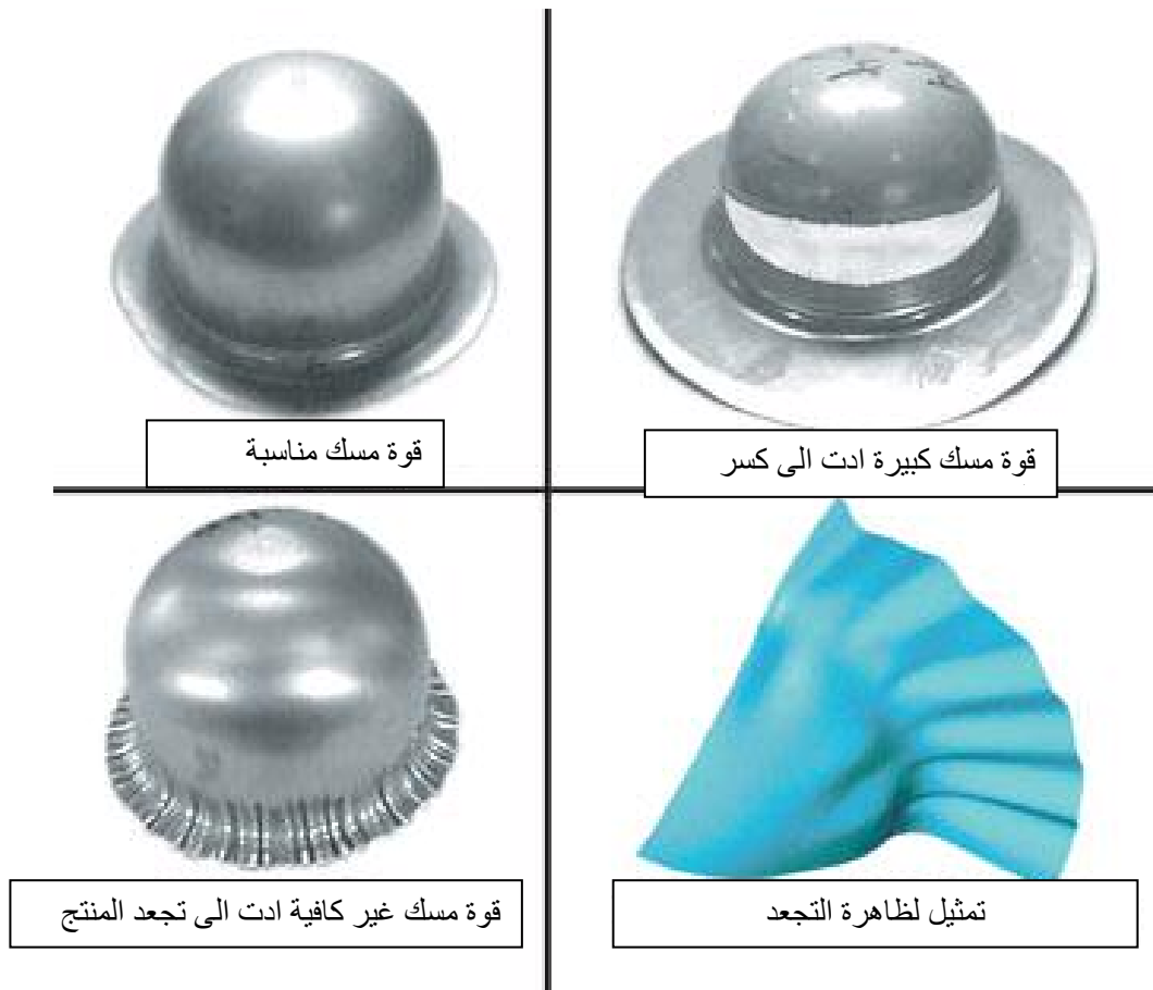
شكل (٧-٤٠) تأثير قوة المسك على جزدة المنتج المسحوب
