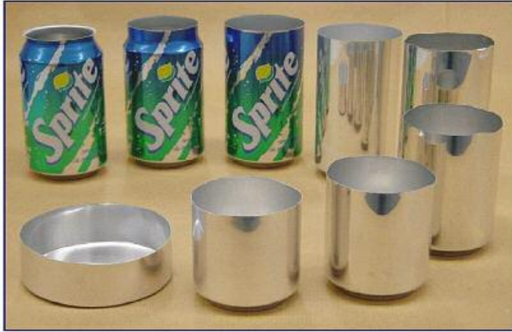
شكل (٧-٣٦) مراحل السحب العميق المتعددة لانتاج اوعية الصودا
