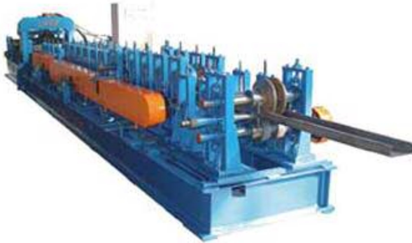
شكل (٣-٩) خط درفلة لانتاج مقطع C
