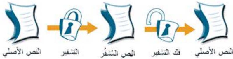
الشكل 1-1-2 يوضح عملية لتشفير وفك التشفير
