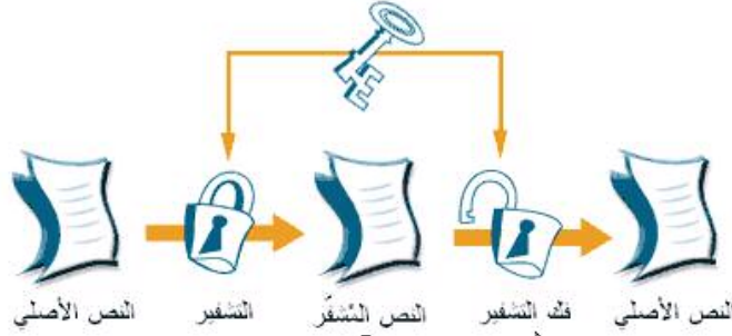
الشكل 2.2.4 يمثل التشفير باستخدام المفتاح
