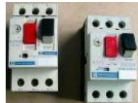
كل ماتور يكتب على جسده قيمة الـ  $( I_{f,L} )$  هذه القيمة تعني أقصى قيمة تيار " أمبير " يستطيع المotor تحملها , فعند توصيل أوفرلود مع المotor , يتم ضبطه على قيمة تساوي  $I_{o,L} = 1.1 \text{ to } 1.25 I_{f,L}$  ويتم توصيله قبل الكوناتكتور أو بعده , كما هو موضح في الرسم التالي :
