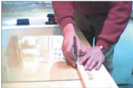
شكل (٨): شخص يقص الزجاج بالماسة
