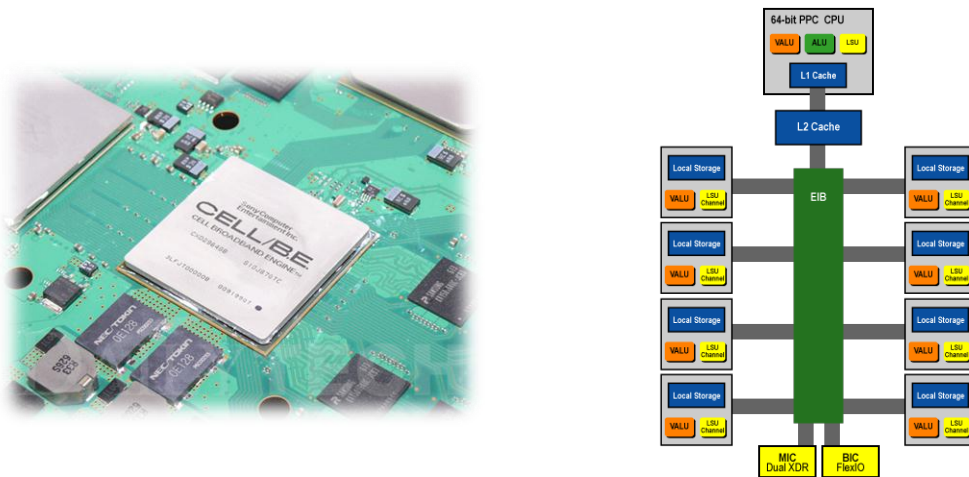
الشكل 25 المخطط الصندوقي للمعالج Cell-Processor
