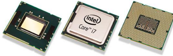
الشكل 22 شريحة المعالج Intel®i7 رباعي النوى وذو ناقل بعرض 64-Bit ويحوي على 731 مليون ترانزستور
