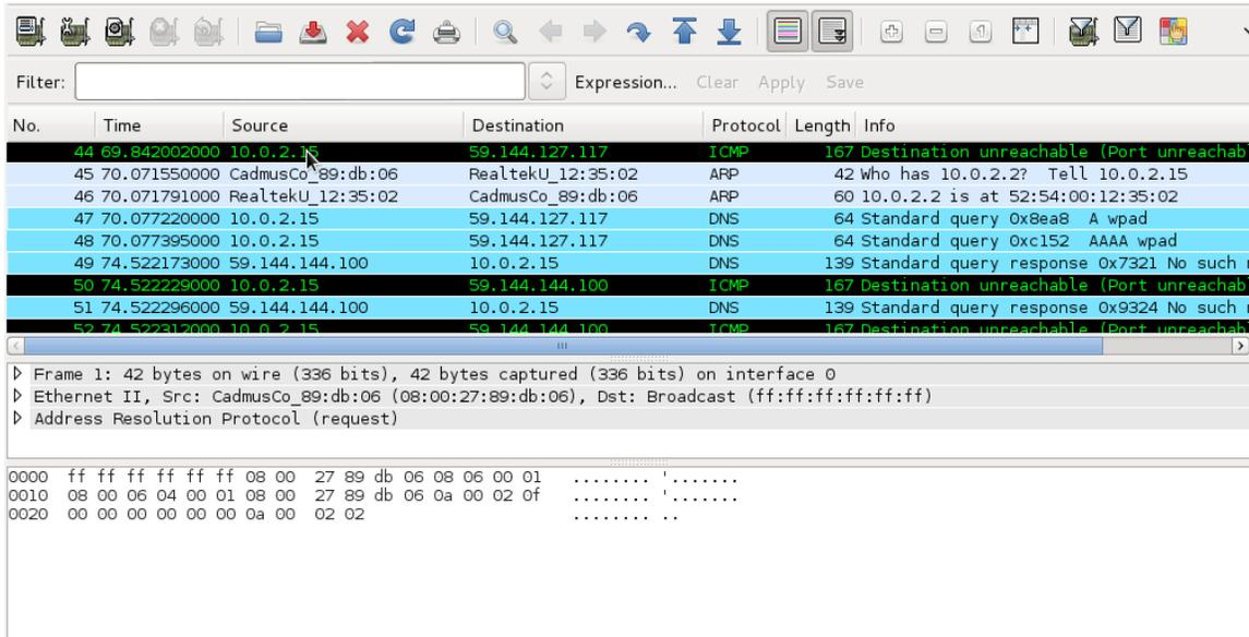
سوف تلاحظ أن الواجهة الرسومية لهذا البرنامج مقسمة إلى ثلاثة أقسام. Capture panel تظهر إلتقاط الحزم مباشرة. Packet details panel تظهر معلومات عن الحزمة المختارة من capture panel. Packet bytes panel تمثل المعلومات من packet details بالصيغة الحقيقية لها. تظهر تسلسل البايتات المتدفقة. يمكن إختيار عدة خيارات من قائمة options لزيادة فعالية الإلتقاط.
