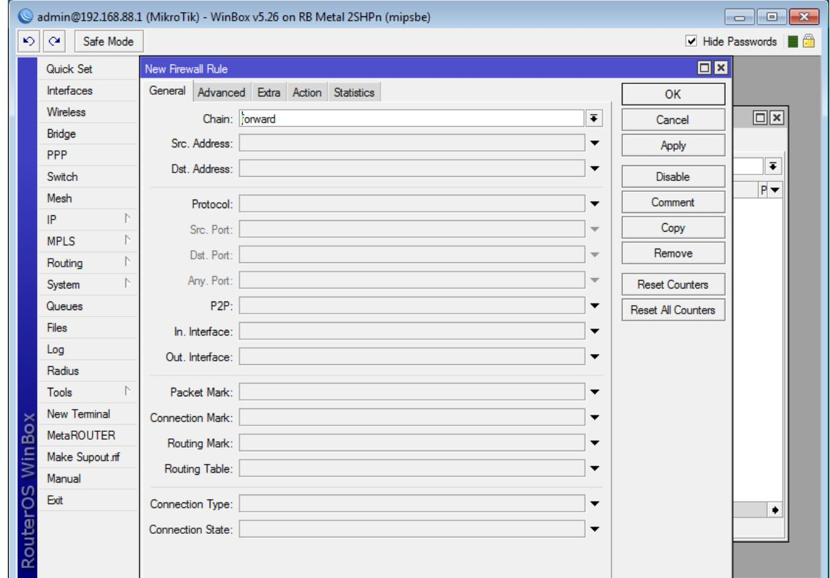
والآن نصل الى كيفية اختيار السلسلة وهل هي (forward, input, output) وكما يلي:
