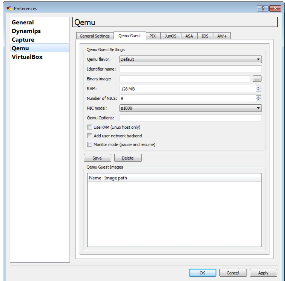
نقوم بادخال اسم الجهاز وليكن (mikrotik) ونقوم بتحديد الصورة النهاية (binary) كما في النافذة التالية:
