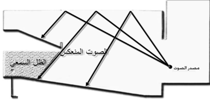
- قطاع فى صالة توضح عيوب الاسقف الأفقية .
