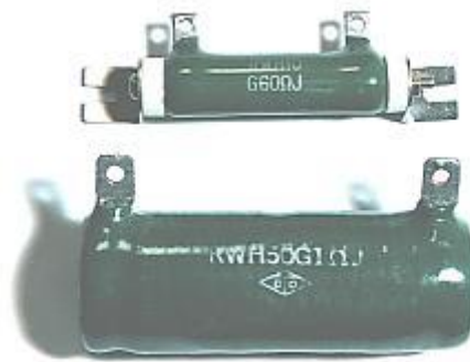
الصورة تبين المقاومة السلكية (معزولة بطبقة من السيراميك)
