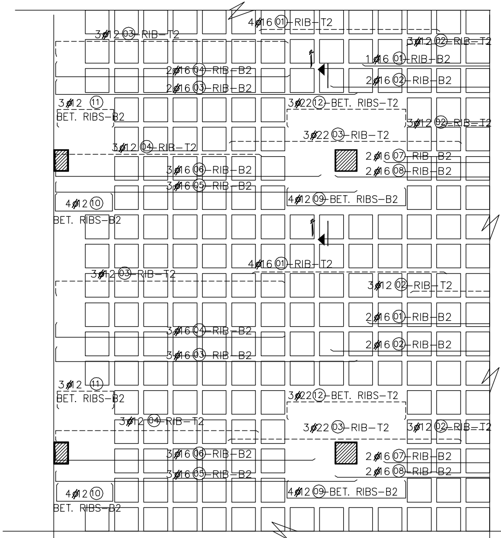
شكل رقم (٧-١) تفاصيل تسليح البلاطات المسطحة ذات الأعصاب
