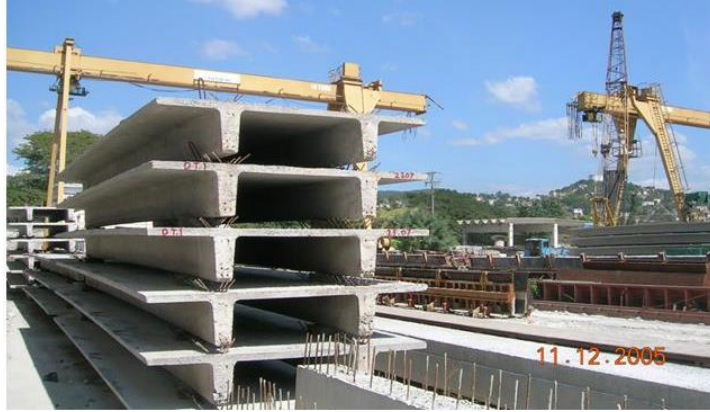
شكل (10) يوضح وحدات مزدوجة على شكل حرف T
