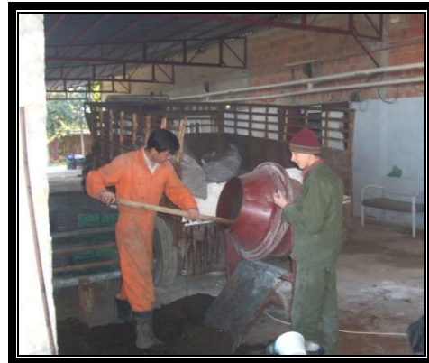
استخدام جبالة الإسمنت لخلط مكونات تربة التغطية، حيان، حلب، 2007.
