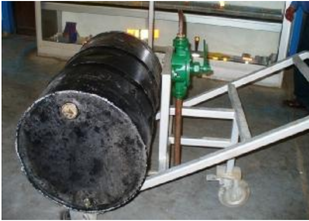
الشكل رقم (٩) يوضح المعدة المستخدمة لإجراء عملية الرش للمستحلب الاسفلتي
