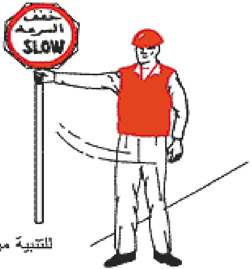
الشكل رقم (١١٠) يوضح استخدام وسائل الإشارة اليدوية بواسطة حاملو الرايات
