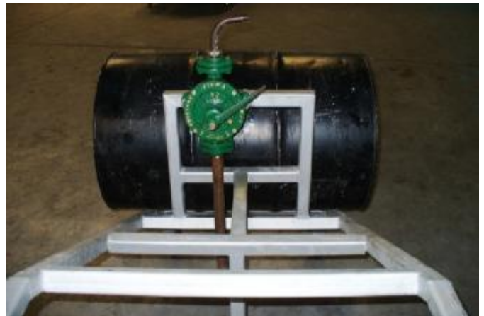
الشكل رقم (٩) يوضح المعدة المستخدمة لإجراء عملية الرش للمستحلب الاسفلتي
