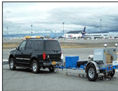
الشكل رقم (١٤١) يوضح تشغيل ومبادئ الحمل الساقط الثقيل (HWD)
