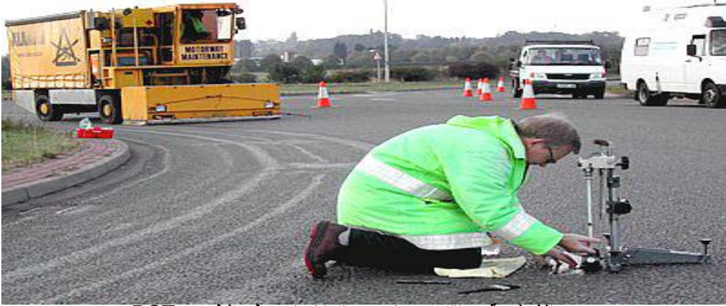
الشكل رقم (١٣٦) يوضح جهاز إختبار سطح الطريق RST
