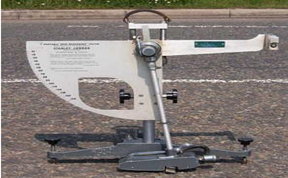
الشكل رقم (١٣٧) يوضح جهاز قياس مقاومة الإنزلاق
