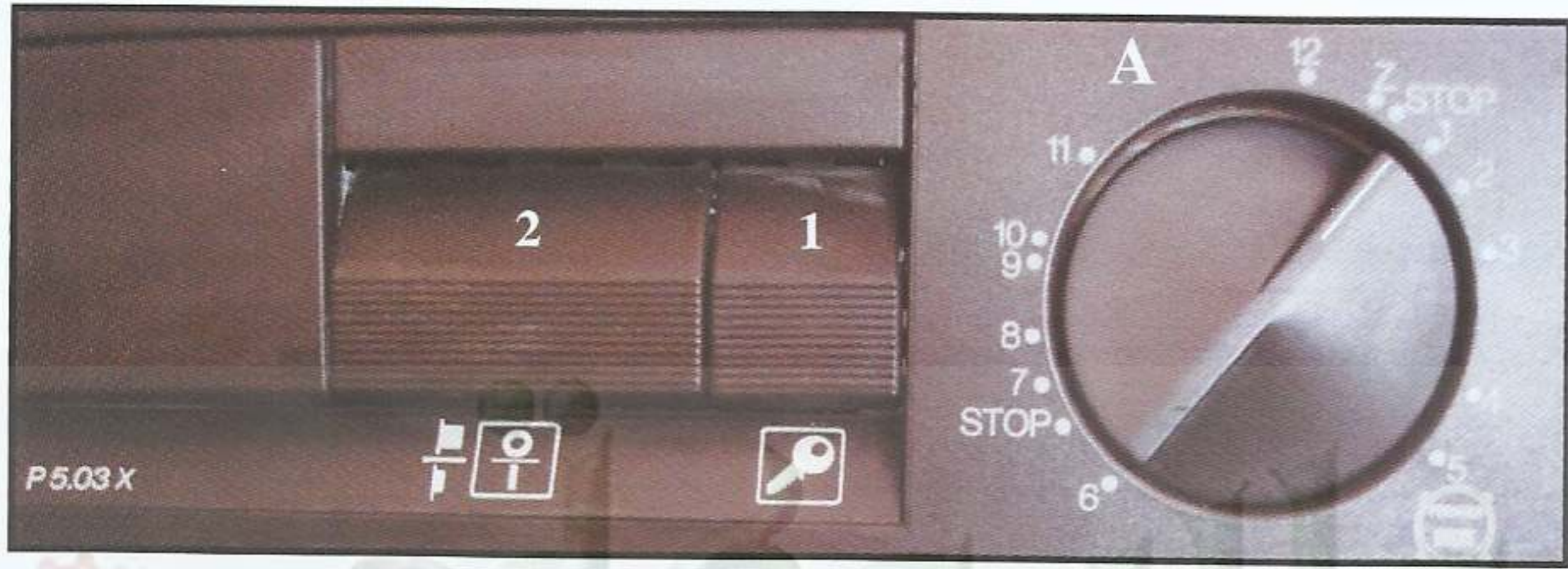
Ⓐ أكرة التيمر ① مفتاح الباب ② مفتاح تشغيل
