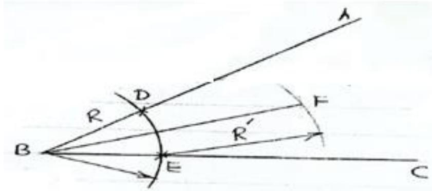
2.3 تحديد مركز قوس (To find the center of an arc):
