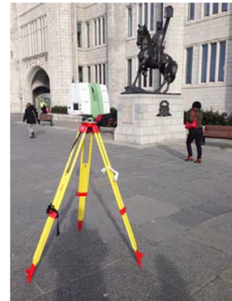
الماسحة الضوئية Leica C10 3D Scanner المستخدمة في مسح التماثيل
