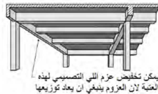
شكل (5-8) يمكن تخفيض عزم اللي التصميمي في هذا الشكل
