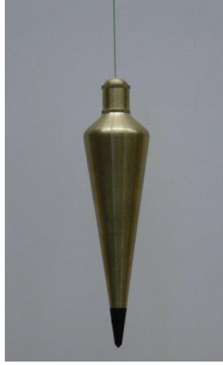
شكل 16: ثقل الشاقول والذي يستخدم لتعديل الشدادات لضمان شاقولية البرج.
