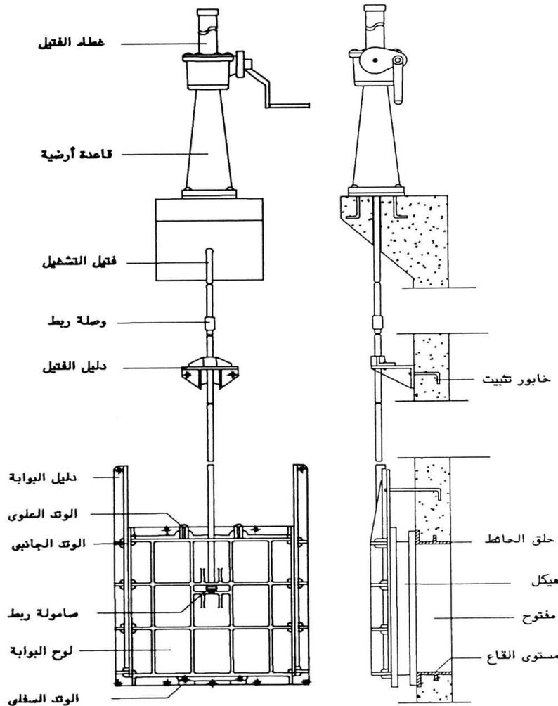
يتحكم صمام البوابة في المياه الواردة من ماسورة الانحدار إلى حيز أو مكان مفتوح كالبيارة في محطة الرفع أو محطات المعالجة، وكذلك في محطات تنقية المياه، ولذا فإن هذا النوع يستعمل في محطات تنقية مياه الشرب ومحطات معالجة الصرف الصحي.
