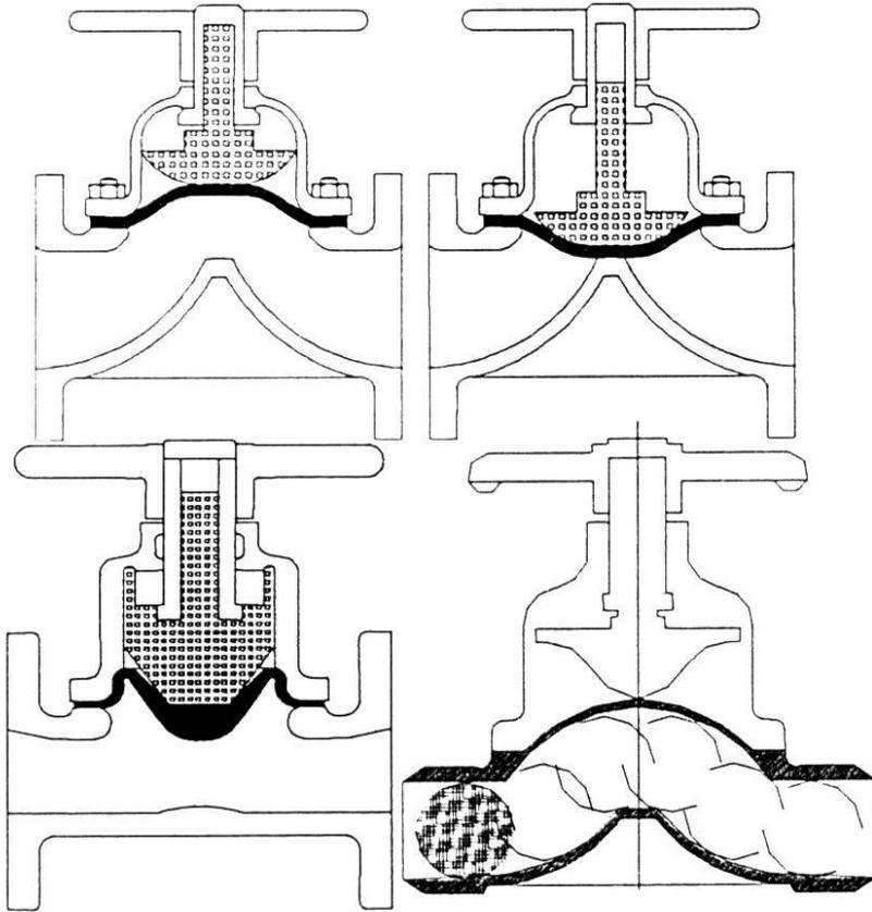
يتميز هذا النوع بوجود غشاء مرن (مطاط) داخل جسم الصمام يمكن تحريكه عن طريق عامود متصل به. وعند تحريك الغشاء تضيق فتحة الصمام أو تتسع وبذلك يتم تنظيم التصريف والتحكم فيه. ويستخدم هذا الصمام عادة في نقل وتداول المواد الكيماوية السائلة مثل محلول الشبة أو الكلور في محطات المياه لأن غشاء المطاط يكون مقاوم للمواد الكيماوية وبذلك يتم إطالة عمر الصمام بعدم وجود تلامس مباشر بين الجسم المعدني للصمام والمواد الكيماوية.
