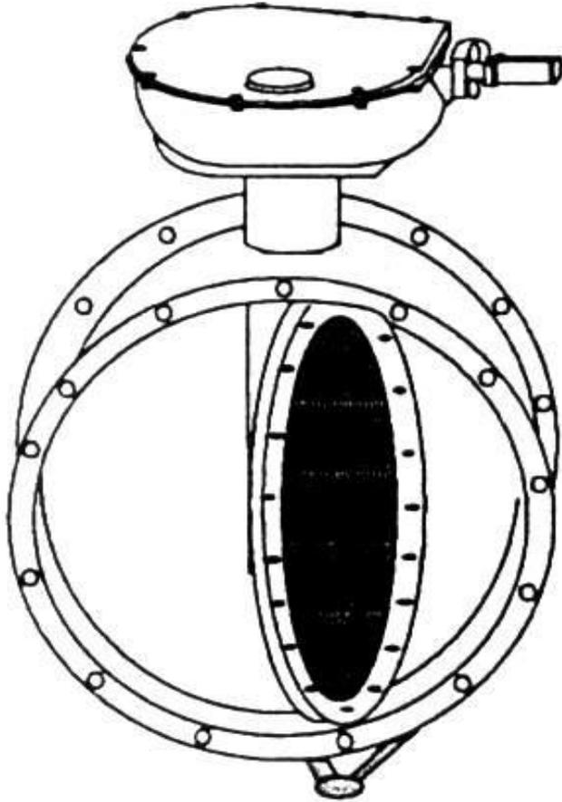
محبس الفراشة هو صمام حاجز يتحمل الضغوط العالية، ويستخدم في أعمال المياه. ويمتاز هذا النوع بخفة الوزن وصغر الحجم وسهولة التشغيل وينتج بأقطار مختلفة من 100 مم وحتى 3200 مم، ويمكن للأقطار الكبيرة أن تزود بماتور للفتح والغلق، ويصنع المحبس من الزهر المرن، وأحياناً يصنع من الصلب المقاوم للصدأ ويدهن بمادة الإيبوكسي. والأجزاء الرئيسية لهذا المحبس هي: الجسم-القرص-عامود الإدارة.
