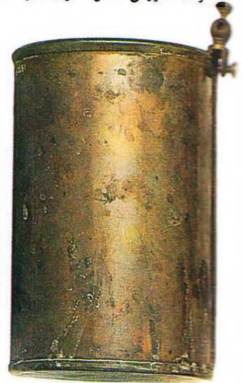
علبة من النحاس تقوم بدور قطب كهربائي
