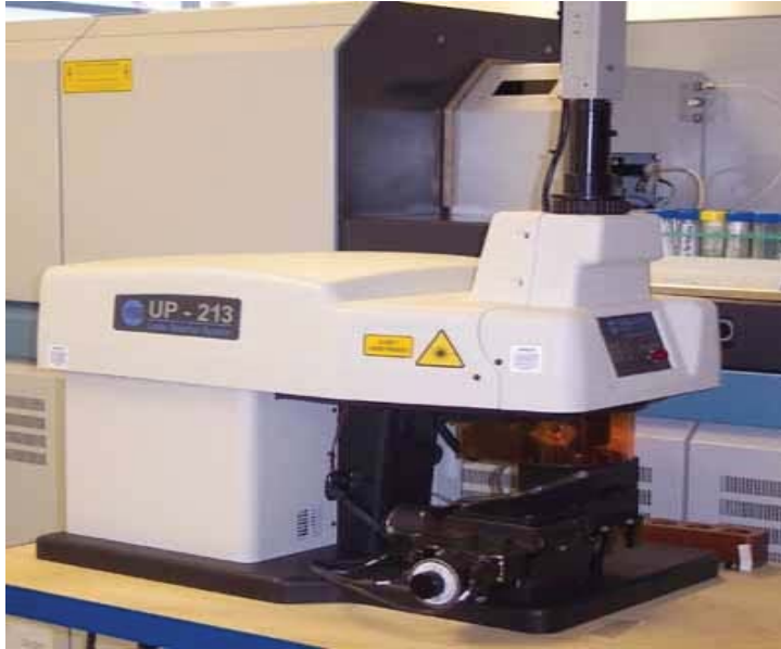
شكل رقم (٣-١٨) صورة توضيحية لطريقة عمل جهاز الاستقطاع الليزري المعدل المستخدم في تصنيع أنابيب الكربون النانوية (٢٤).
