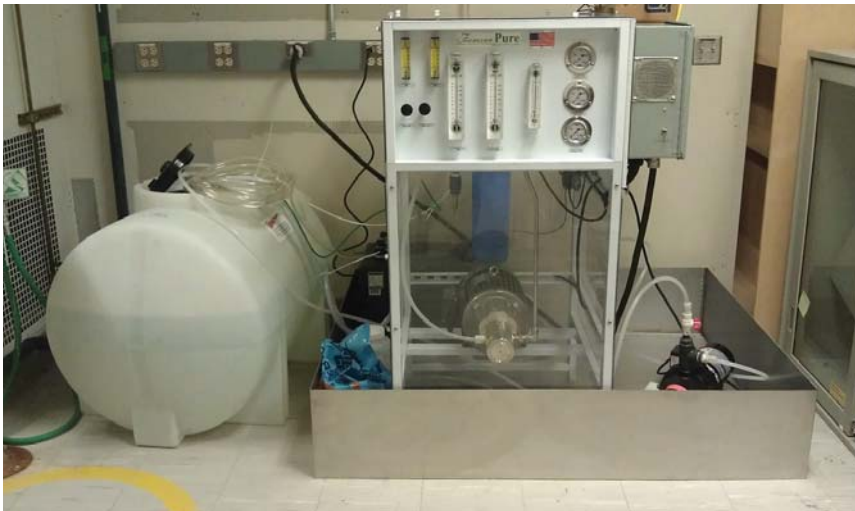
شكل رقم (٥-٥) جهاز لتقييم الأغشية الحلزونية تحت الضغط العالي SWRO-70 مشابه للموديل الصناعي (٩٤).
