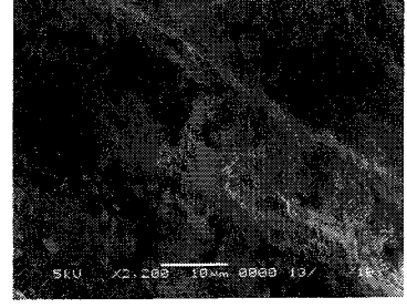
لوحة ١٠ الفحص باستخدام الميكروسكوب الإلكتروني الماسح لعينة من الحامل الخشبي وظهور تدهور شديد في خلايا الحامل الخشبي.
