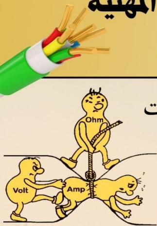
**المقاومة الكهربائية**: هي مقدار ممانعة سريان الالكترونات في الدائرة الكهربائية وتقاس بالأوم
