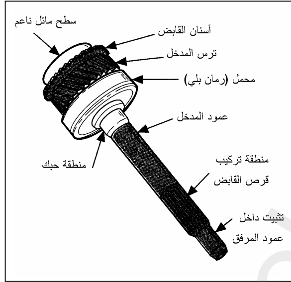
شكل (٢٤) الأجزاء المختلفة لعمود الإدارة (عمود المدخل).
