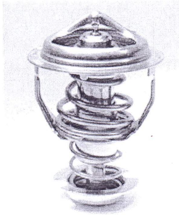
شكل ( 2-2 ) يوضح مكونات المنظم الحراري
