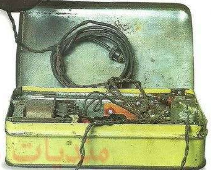
جهاز استقبال لاسلكي مصنوع بالمنزل استخدمته أسرة هولندية أثناء الاحتلال
