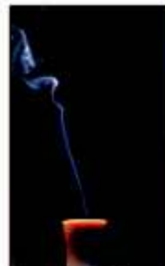
Figure (4-3) Le mouvement de la fumée passe d'un régime laminaire à un autre turbulent
