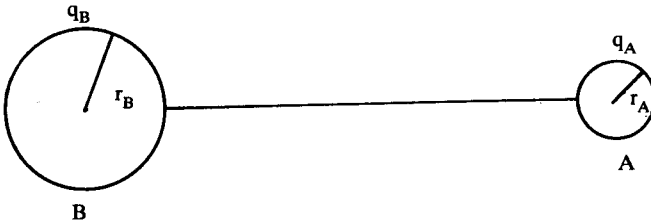
شكل (٢-٨): تقاسم الشحنات بين كرتين نصف قطر الأولى r_A والثانية r_B حيث r_B > r_A
