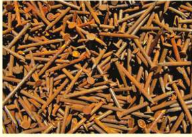
شكل (٣-١١): المسامير يعلوها الصدأ إثر تعرضها للرطوبة.
