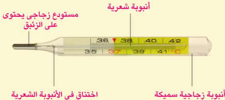
شكل (٢-٨): تركيب الترمومتر الطبي.
