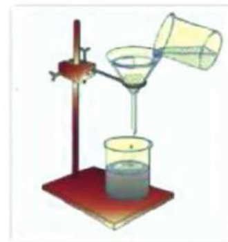
Fig. 38 filtration du mélange pour séparer le sable.
