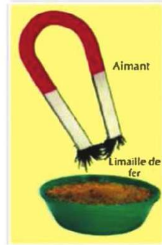
Fig. 37 on sépare quelques matières solides fabriquées en fer par l'attraction magnétique.
