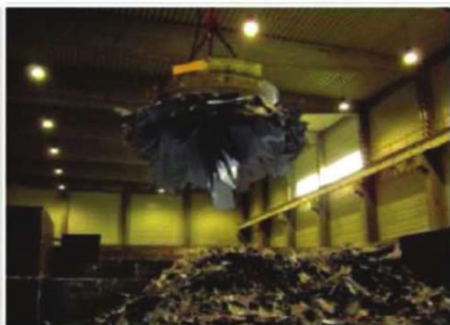
Fig.27 L'électroaimant attire les pièces de fer et quand on interrompt le courant électrique, l'électroaimant perd son aimantation et les pièces en fer tombent.
