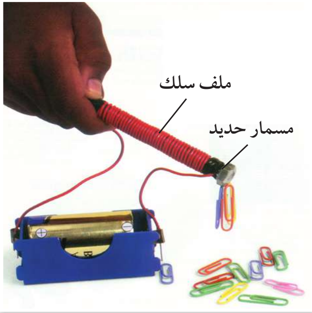
شكل (٢٦): تنجذب المشابك المعدنية للمغناطيس عند غلق الدائرة الكهربائية.
