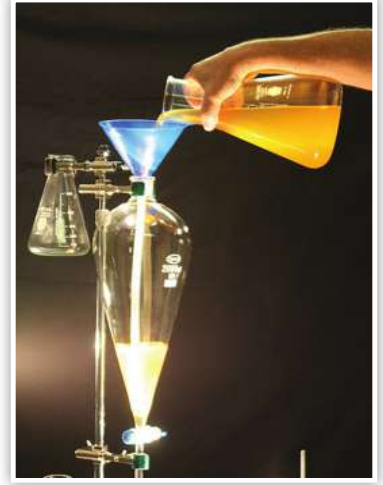
شكل (٣٦): قمع الفصل يستخدم لفصل السوائل غير المتجانسة.
