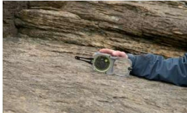
شكل 6-4 قياس ميل سطح بواسطة نموذجي بوصلة برنتون و أونيفيرسيل.
