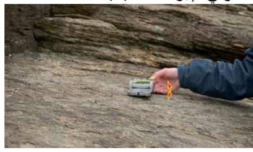
شكل 6-3 قياس اتجاه سطح بواسطة نموذجي بوصلة برنتون وأنيفيرسيل.
