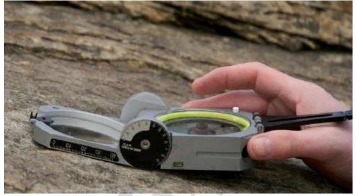
شكل 6-2 قياس سمت ميل سطح بواسطة نموذجي بوصلة برنتون وكلا.
