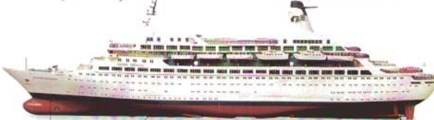
أَهْبَكُلٌ مُعَدِينِ Metal hull قُوَّةُ دَفْعِ المِيزَانِ إلى أَعلى تُساوي الدَّفْعَ السُّفِينِيَّ أَي وَزْنَ السُّفِينَةِ Uplthrust force from the water equals the downward force of the ship's weight
