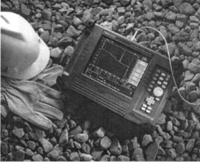
الشكل 8-11 مقياس (OTDR) متنقل، نموذج سي أم أي 4000 (CMA4000) للاستعمال الميداني (تقدمة شركة نت تست)
