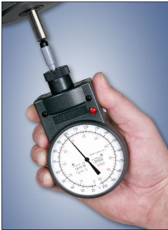
شكل (5) آلية عمل التاكوميتر
