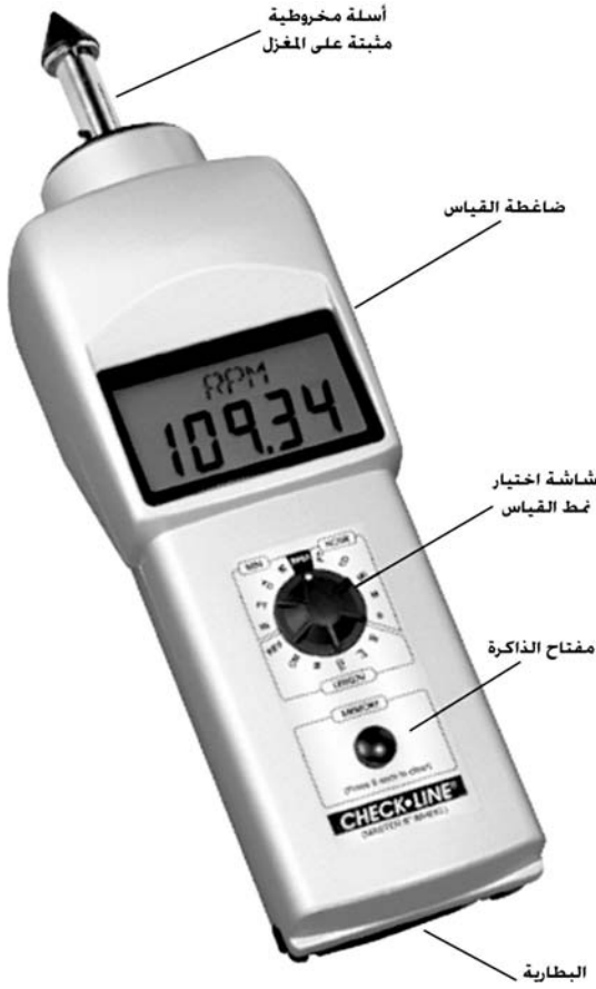
شكل (11) التاكوميتر الإلكتروني بتماس دوار
