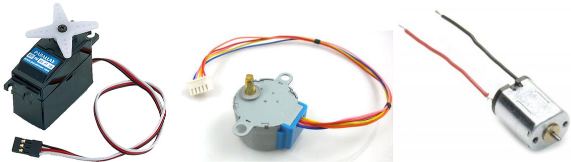
**طريقة الاختبار:** اختبر الملفات الداخلية باستخدام الملتيميتر . أو وصل الدخل المناسب و شاهد حركة المحرك.
