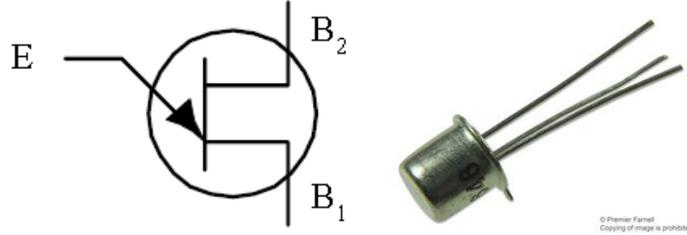
**العمل:** يشبه كثيراً ترانستور من نوع الـ JFET سوى أنه يختلف في الحجم ومادة التصنيع. يمكن تصنيع دوائر مذبذبات (دوائر توليد الإشارات) بسهولة بالغة بهذا النوع. مثل الشكل التالي:
