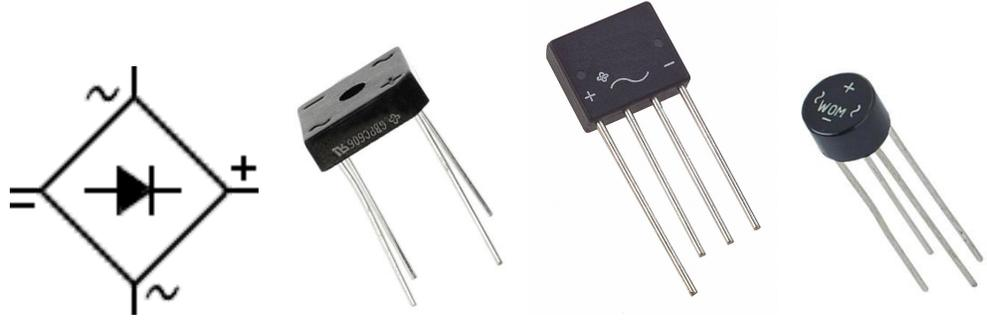
**العمل:** تعمل القنطرة على تحويل الكهرباء المترددة إلى مستمرة . و تتكون داخلها من أربع موحدات متصلة ببعضها.
