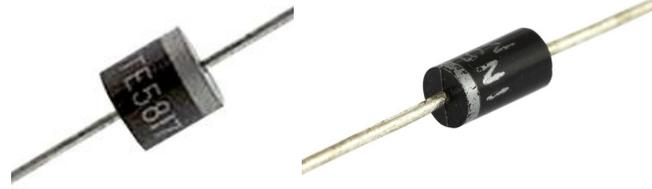
**العمل:** يعمل الدايدود على السماح بمرور التيار في اتجاه واحد (عندما يتصل الموجب بالأنود ، و السالب على الكاثود) و يمنع التيار في حالة التوصيل بالعكس.
