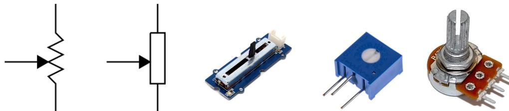
**العمل :** تعمل المقاومة المتغيرة على معاوقة مرور التيار (مثل المقاومة العادية) ، سوى أنه يمكن تغيير قيمتها يدوياً
