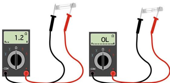
**طريقة الاختبار:** يستخدم جهاز الملتيميتر لاختبار الفيوز ، و الطريقة سهلة و هي أن تضبط الملتيميتر على وضع الزنان أو قياس المقاومة ثم توصل أطراف الملتيميتر إلى أطراف الفيوز ، يكون الفيوز الجيد موصلاً بينما الفيوز التالف يكون مقطوعاً.
