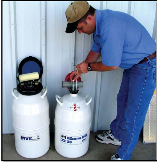
صورة (10-1) خزانات النايتروجين السائل المستعمل في حفظ السائل المنوي
