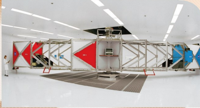
الشكل 9.1 يُعزّض جهاز الطرد المركزي التابع لوكالة ناسا الذي يولد عجلة مقدارها 20 g رواد الفضاء والمعدات لقوى g مشابهة لتلك القوى التي توجد أثناء إطلاق الصاروخ.
