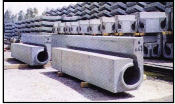
مجارى خرسانية لتصريف مياه الأمطار (نفق الأزهر)
