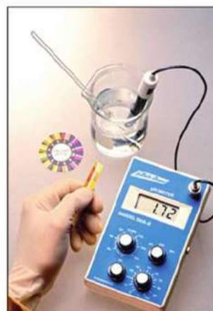
▲ Figure (15) Appareils utilisés pour mesurer le pH
