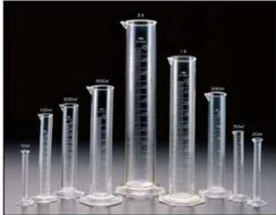
▲ Figure (7) Les cylindres gradués à différentes capacités
