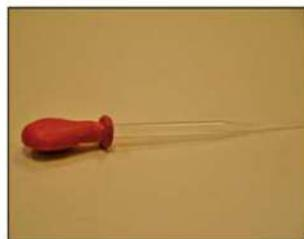
▲ Figure (13) La pipette avec moyen d'aspiration
