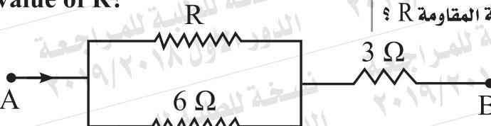
٣٩- في الدائرة المبينة بالشكل، إذا كانت المقاومة المكافئة للجزء  $AB = 5\Omega$ ، فما قيمة المقاومة  $R$ ؟
