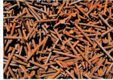
Fig. (3-11) : Les clous surmontés par la rouille dû à leur exposition à l'humidité.
